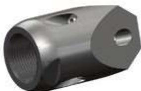
форсунка каналопромывочная с боем вперед и назад предназначена для устранения сложных засоров. 4 струи направленных вперед(3 под углом и одна прямая) суммируют пробивную мощность в точке схождения, а затем расширяют пробойну до диаметра форсунки, после чего форсунка проходит в отверстие и задними струями разрушает засор.
