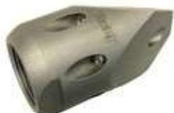
форсунка каналопромывочная с боем вперед и назад предназначена для устранения сложных засоров. 4 струи направленных вперед (3 под углом и одна прямая) суммируют пробивную мощность в точке схождения, а затем расширяют пробой до диаметра форсунки, после чего форсунка проходит в отверстие и задними струями разрушает засор.
