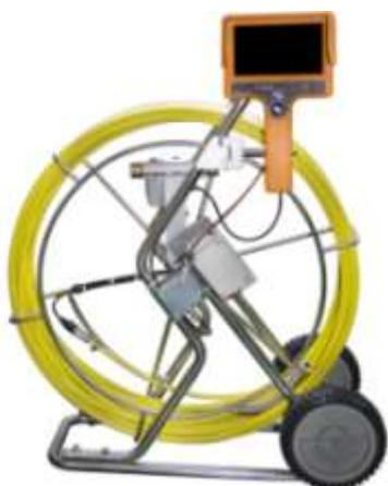
Данная система используется для видеодиагностики и телеинспекции трубопроводов канализации. Применяется при видеоинспекции труб диаметром до 500 мм и длиной до 120 метров. Максимальная дистанция для проведения безразборной диагностики канализации составляет 230 м. (По 115 метров с каждой стороны).
